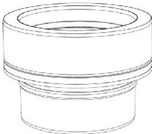
Figura 4.8, Adaptador simple a doble (37)
