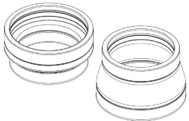
Figura 4.10, Ampliación (A) y reducción (R) concéntricas
