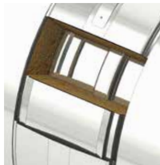
Sistema de unión Macho-Hembra con abrazadera 2.0 exterior.
