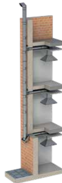
VENTILACIÓN CON CANALIZACIÓN INTERIOR
