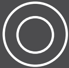
Concéntrico doble pared sin aislar
