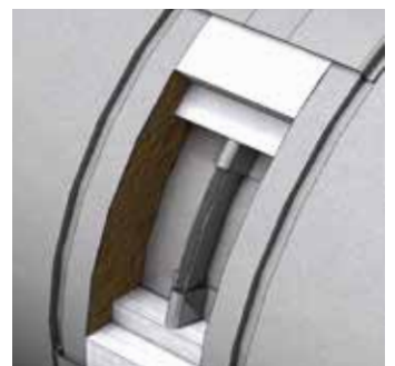
Sistema de unión Macho-Hembra, embreado, con abrazadera V-band interior y 2.0 exterior
